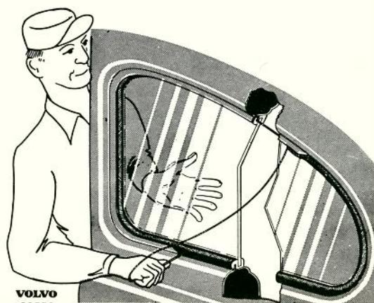
Bild 50. Fastsättning av sidoruta
