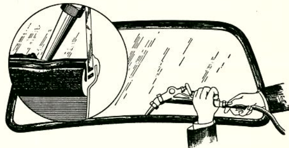
Bild 46. Inpressning av tätningsmedel
