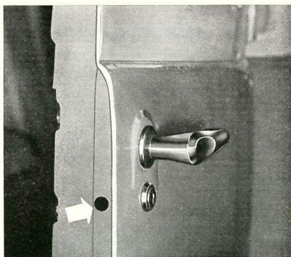
Bild 34. Demontering av låscynder, bakdörr P 210
