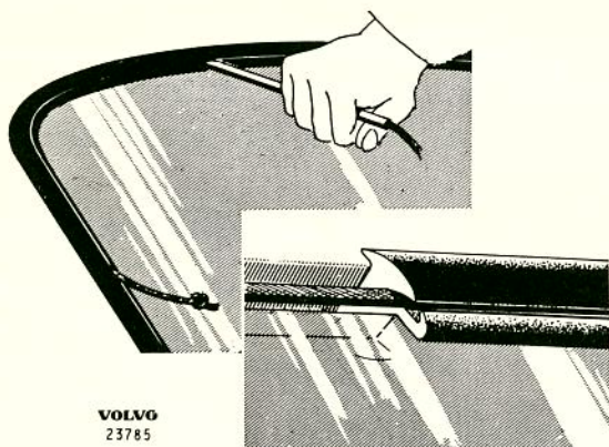
Bild 47. Montering av "snöre" för prydnadslis
